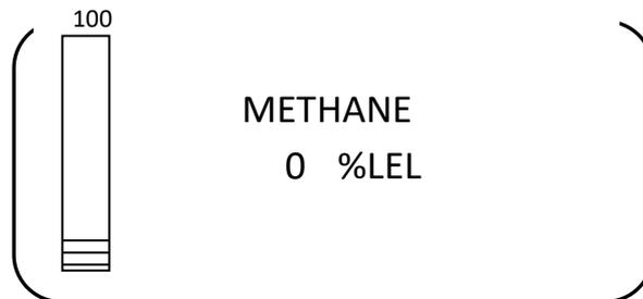
Der Detektor muss sich aufwärmen, um bei eingeschalteter Stromversorgung bereit zu sein. Während dieser 2-minütigen Aufwärmphase werden die Statusmeldungen oben rechts auf dem Bildschirm angezeigt. Auch die Fehler-LED leuchtet.
